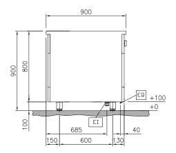
Electrical inlet (power) EQ **Equipotential screw**
